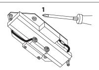
2 Seile ausrollen und von unten durch die äußeren Bohrungen des Gegengewichts ziehen (1). Anschließend durch die Stirnseite der schwarzen Justierschraube (2), dann durch den Klemmring fädeln (3).
